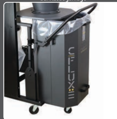
Ausgeklügeltes Hebelsystem zum Fest- klemmen des Abfallbehälters
