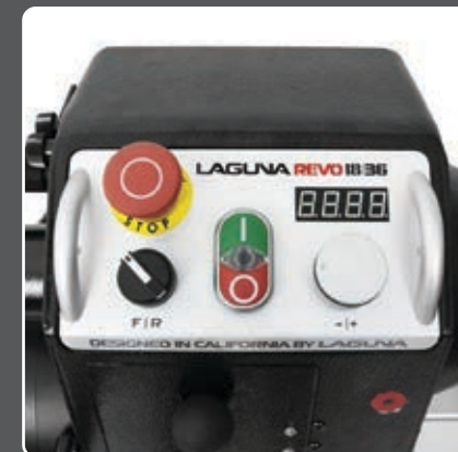
Bedienpanel mit digitaler Geschwindigkeitsanzeige
