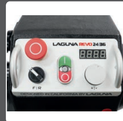
Bedienpanel mit digitaler Drehzahlanzeige
