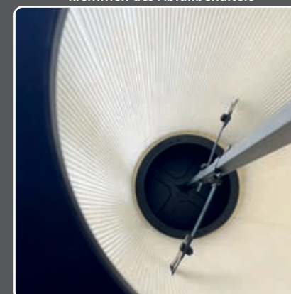
Reinigung der Filterpatrone ohne Demontage
