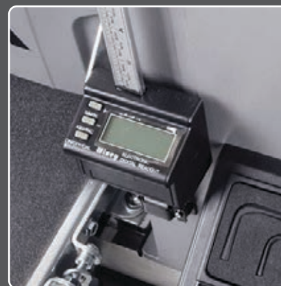
Digitalanzeige der Werkstückdicke
