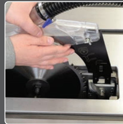
Schnelle Befestigung des Spaltkeils
